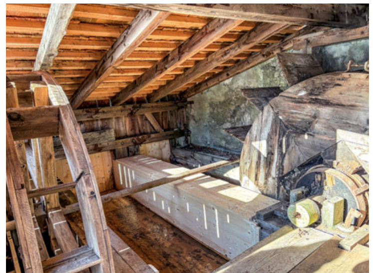
Zwei der drei Wasserräder sind wieder funktionstüchtig, das dritte (ganz rechts) leider durch die lange Nicht-Verwendung nicht mehr.
