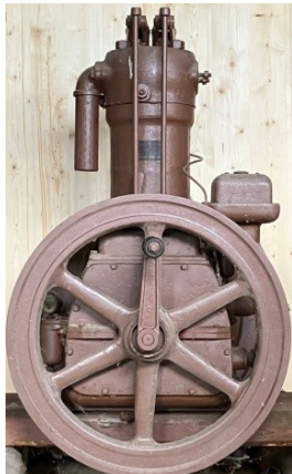
Abb.: Schlüter-Motor Typ HR 110 (Quelle: Verein Mühle in Rien)
