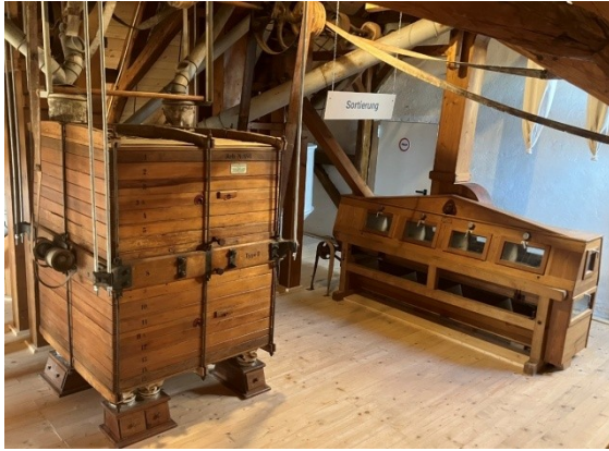
Abb.: Reformplansichter (li) und Grießputzmaschine (re) in der Mühle in Rien (Quelle: Verein Mühle in Rien)
