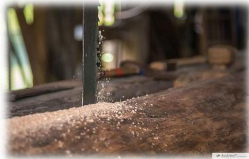
Mühle und Säge waren in früheren Zeiten wirtschaftlich und räumlich eng miteinander verflochten, auch die Furthmühle beherbergte Mühle und Säge. Ein beeindruckendes Zeugnis für ursprüngliche Sägewerkstechnik ist der **Venezianergatter**. Diese von einem Wasserrad angetriebene Einblattsäge stammt aus Hirschbach bei Freistadt und zeigt den Stand der Sägetechnik um 1800. Die Einrichtung der Säge der
