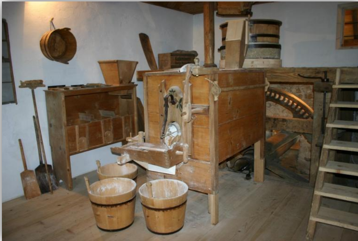
Der Steingang mit Beutelkasten. Links davon befindet sich die Gießputzmaschine mit Windsichtung. 2017
