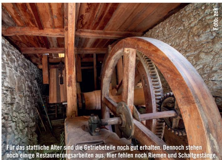
Für das stattliche Alter sind die Getriebeteile noch gut erhalten. Dennoch stehen noch einige Restaurierungsarbeiten aus. Hier fehlen noch Riemen und Schaltgestänge.
